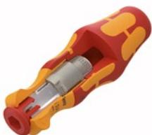
Das neue VDE Schraubwerkzeug 837 i RA von Wera mit einer im Griff integrierten Ratsche setzt noch eins oben drauf: Die Geometrie dieser Ratsche macht den Handhalter nicht klobig sondern schlank, sodass es sich auch in engen Bauräumen gut arbeiten lässt. Die Ratsche ist mit 40 Zähnen ausgestattet, was für einen kleinen Rückholwinkel von 9°
