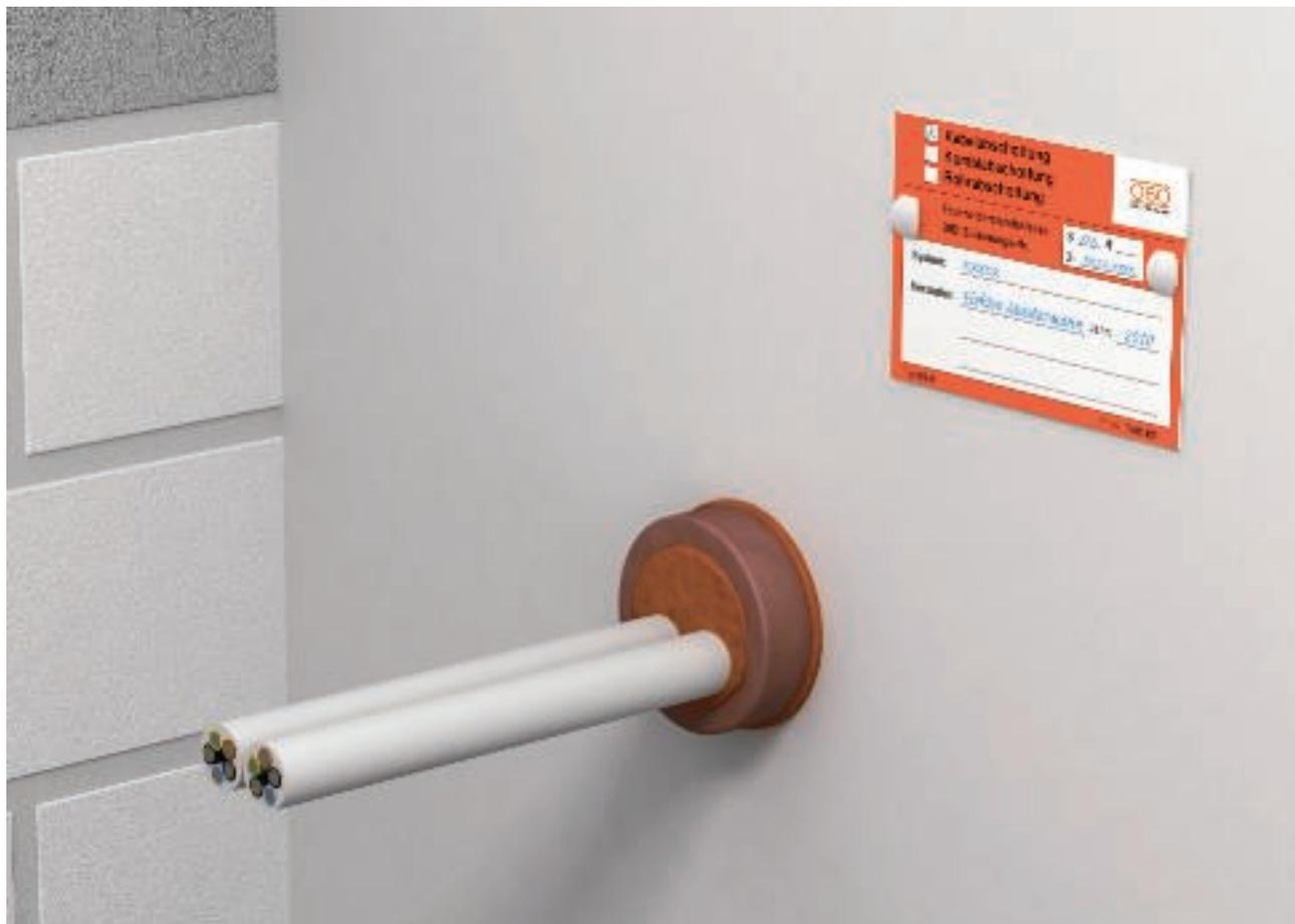
OBO FBA-SP ist die schnelle und einfache Möglichkeit, um kleine, runde Kabelabschottungen zu installieren. Die Brandschutzspachtelmasse dehnt sich im Brandfall aus und isoliert so entstandene Öffnungen. Für die Kabelabschottung werden
