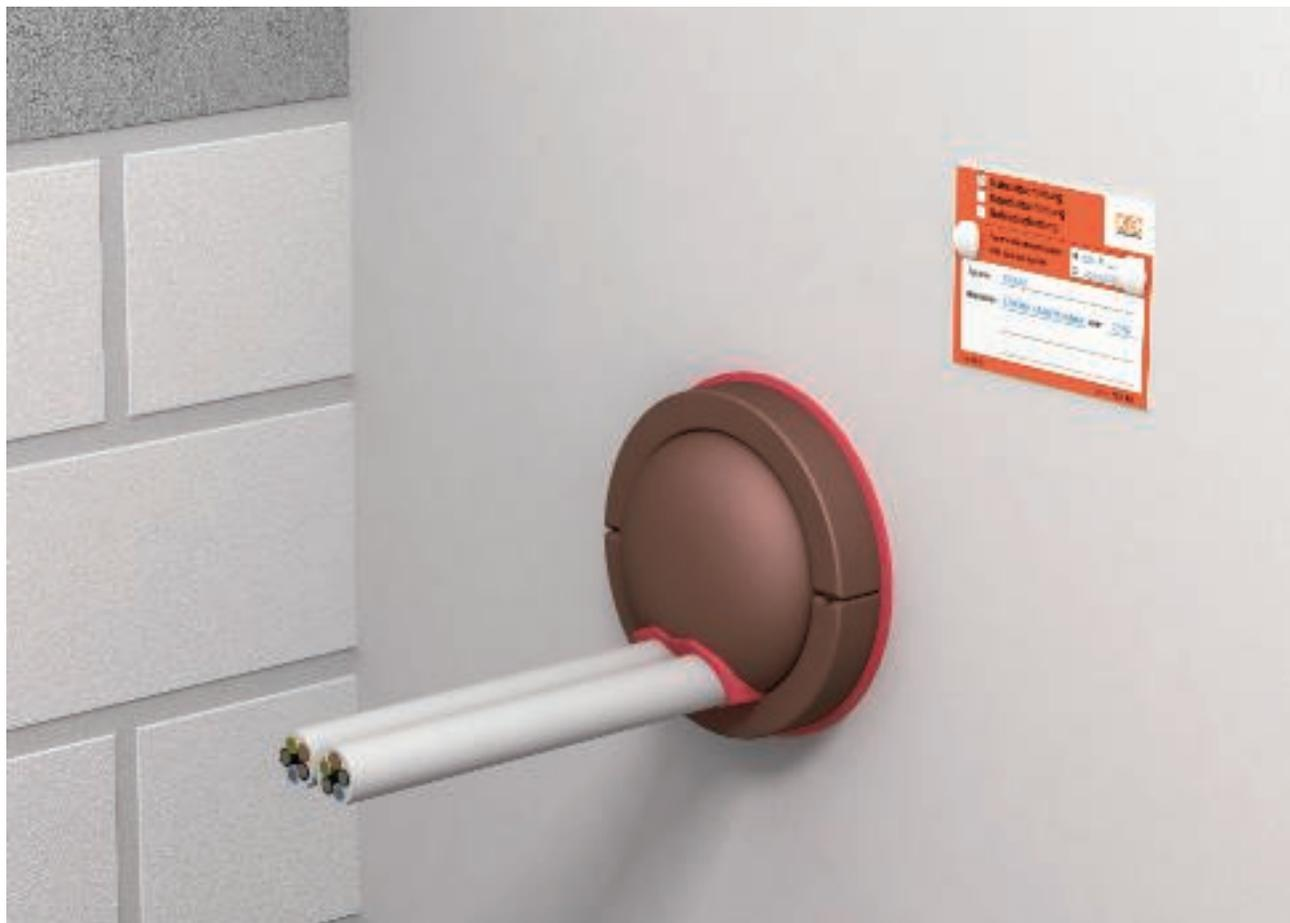
OBO FBA-SR ist die ideale Lösung für runde Kabelabschottungen in leichten Trennwänden. Der Einbau in Massivwänden und Massivdecken ist ebenfalls möglich und zulässig. Das Fertigteil-schott besteht aus einer zweigeteilten, festen Rohrschale mit einem Außendurchmesser von
