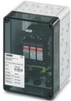
Generatoranschlusskasten; MPP-Spannung: 1000 V DC; String-Anzahl: 1; Anzahl der unterstützten MPP-Tracker: 1; Überspannungsschutz: T1 / T2; Art der Leitungseinführung: MC4-Evo 2; Lieferumfang: ohne DC-Steckverbinder für den Anschluss des GAKs
