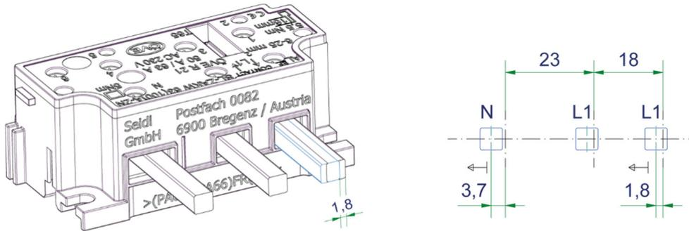
Das einzigartige und zugleich innovative Merkmal ist der seitliche Versatz der Zähleranschlussstifte von bis zu 3,6 mm (1,8 mm je Seite). Dadurch können alle derzeit verwendeten Energiezähler und Smartmeter mit der Anschlussklemme SL-ZAKW angeschlossen werden.
