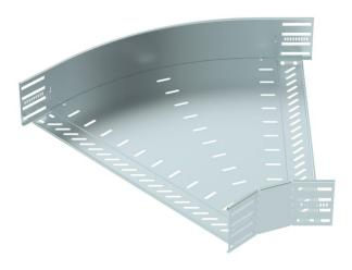
45°-Bogen zum Erstellen einer horizontalen Abzweigung, Formteil für rast- und schraubbare Kabelrinnen Seitenhöhe 110 mm. Schraubenlose Montage mit Doppelklemmen oder Schraubverbindung mit Flachrundschrauben FRS und Kombimuttern M6. Einsetzbar im Innenbereich. Befestigungsmaterial muss separat bestellt werden.
