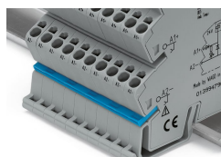
Brücken statt einzeln verdrahten – Brückbarkeit durch Konturengleichheit auf allen Anschlussebenen
