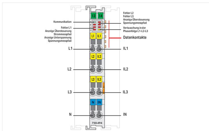
Das 3-Phasen-Leistungsmessmodul 750-494 ermöglicht die Messung der elektrischen Daten eines dreiphasigen Versorgungsnetzes.
