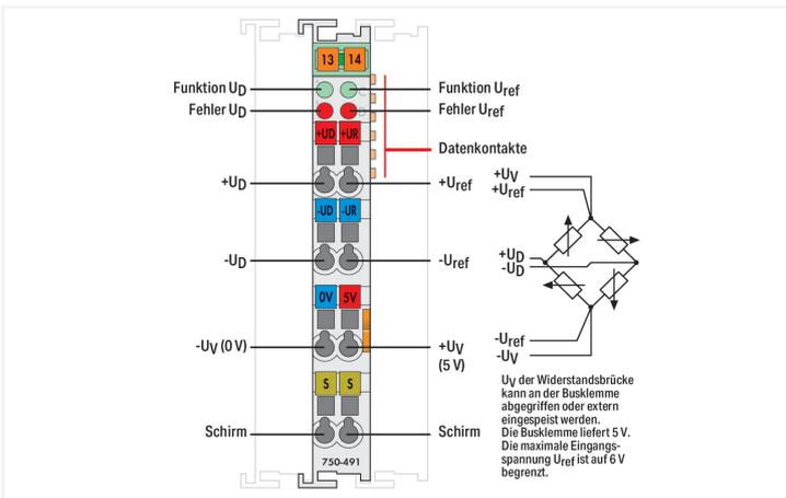
Das Modul ermöglicht den direkten Anschluss einer Widerstandsbrücke. Die Brückenspannung  $U_D$  und die Versorgungsspannung  $U_{ref}$  der Brücke werden mit einer Auflösung von 16 Bit digitalisiert.
