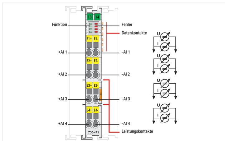
Das Analogeingangsmodule verarbeitet vier Differenzsignale vom Typ Spannung und Strom.
