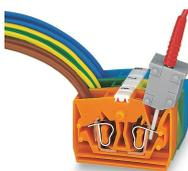
Prüfen über CAGE CLAMP®-Anschluss an der Stromschiene – möglicher Nennstrom 6 A; Durch CAGE CLAMP®-Betätigung können einzelne Prüfkontakte geklemmt werden. Die maximale Prüfspannung beträgt 400 V.
