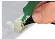
Litzenverdichtete Leiter anschließen – Klemmstelle mit Schraubendreher öffnen.
