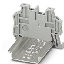
Schnellmontage-Endhalter, für Tragschiene NS 35/7,5 oder Tragschiene NS 35/15, mit Markierungsmöglichkeit, mit Parkmöglichkeit für FBS...5, FBS...6, KSS 5, KSS 6, Breite: 5,15 mm, Farbe: grau
