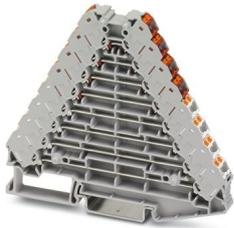
Rangierverteiler, Nennspannung: 250 V, Nennstrom: 8 A, Anschlussart: Push-in-Anschluss, 1., 2., 3., 4., 5., 6., 7. und 8. Etage, Bemessungsquerschnitt: 1,5 mm<sup>2</sup>, Querschnitt: 0,14 mm<sup>2</sup> - 2,5 mm<sup>2</sup>, Montage: NS 35/7,5, NS 35/15, Farbe: grau, Farbe Anschlusselemente: rot, weiß
