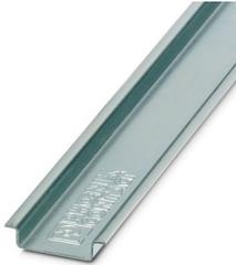
Tragschiene ungelocht, Verpackungsvariante mit 25 Stück (50 m), nach EN 60715, Material: Aluminium, unbeschichtet, Standardprofil, Farbe: silberfarben
