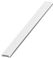
Zackband flach, Streifen, weiß, unbeschriftet, beschriftbar mit: PLOTMARK, CMS-P1-PLOTTER, Montageart: verrasten, für Klemmenbreite: 8 mm, Schriftfeldgröße: 5,15 x 8,15 mm, Anzahl der Einzelschilder: 1000
