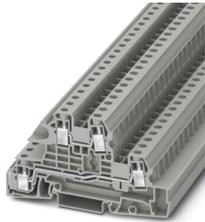
Installationsetagenklemme, Nennspannung: 400 V, Nennstrom: 38 A, Schraubanschluss, Bemessungsquerschnitt: 6 mm<sup>2</sup>, Querschnitt: 0,2 mm<sup>2</sup> - 10 mm<sup>2</sup>, Montageart: NS 35/7,5, NS 35/15, Farbe: grau
