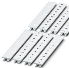
Marker für Klemmen, Streifen, weiß, beschriftet, beschriftbar mit: CMS-P1-PLOTTER, längs: L1, L2, L3, N, PE, L1, L2, L3, N, PE, Montageart: verrasten, für Klemmenbreite: 8,2 mm, Schriftfeldgröße: 10,5 x 8,15 mm, Anzahl der Einzelschilder: 10
