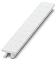
Zackband, Streifen, weiß, unbeschriftet, beschriftbar mit: PLOTMARK, CMS-P1-PLOTTER, Montageart: verrasten, für Klemmenbreite: 8,2 mm, Schriftfeldgröße: 10,5 x 8,15 mm, Anzahl der Einzelschilder: 10
