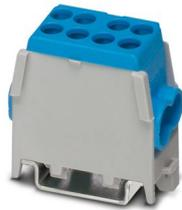
Hauptleitungs-Abzweigklemme, Nennspannung: 400 V, Nennstrom: 101 A, Anzahl der Anschlüsse: 4, Polzahl: 1, Anschlussart: Schraubanschluss, 1. Etage, Bemessungsquerschnitt: 25 mm<sup>2</sup>, Querschnitt: 1,5 mm<sup>2</sup> - 25 mm<sup>2</sup>, Schraubanschluss, 2. Etage, Querschnitt: 1,5 mm<sup>2</sup> - 16 mm<sup>2</sup>, Montageart: NS 35/7,5, NS 35/15, Farbe: blau
