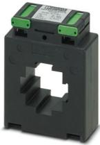
Aufsteckstromwandler, Primärstrom wählbar von 75...1000 A AC; Sekundärstrom wählbar 1 A AC oder 5 A AC; Genauigkeitsklasse wählbar 0,5 oder 1; Bemessungsleistung wählbar
