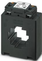
Aufsteckstromwandler mit Schraub- und Push-in-Anschlusstechnik, Anschließen des Leiters bei Push-in direkt von oben, kein Werkzeug ist erforderlich. Wählbar sind: Primärstrom (100 ... 1000) A AC, Sekundärstrom (1 oder 5) A AC, Genauigkeitsklasse 0,5 oder 1, VA-Leistung
