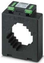
Aufsteckstromwandler, Primärstrom wählbar von 200 ... 1250 A AC; Sekundärstrom wählbar 1 A AC oder 5 A AC; Genauigkeitsklasse wählbar 0,5 oder 1; Bemessungsleistung wählbar
