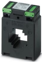
Aufsteckstromwandler, Primärstrom wählbar von 50...750 A AC; Sekundärstrom wählbar 1 A AC oder 5 A AC; Genauigkeitsklasse wählbar 0,5 oder 1; Bemessungsleistung wählbar
