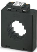
Aufsteckstromwandler mit Schraub- und Push-in-Anschlusstechnik, Anschließen des Leiters bei Push-in direkt von oben, kein Werkzeug ist erforderlich. Wählbar sind: Primärstrom (100 ... 1500) A AC, Sekundärstrom (1 oder 5) A AC, Genauigkeitsklasse 0,5 oder 1, VA-Leistung
