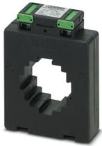
Aufsteckstromwandler, Primärstrom wählbar von 100...1500 A AC; Sekundärstrom wählbar 1 A AC oder 5 A AC; Genauigkeitsklasse wählbar 0,5 oder 1; Bemessungsleistung wählbar
