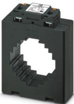
Aufsteckstromwandler mit Schraub- und Push-in-Anschlusstechnik, Anschließen des Leiters bei Push-in direkt von oben, kein Werkzeug ist erforderlich. Wahlbar sind: Primärstrom (200 ... 1600) A AC, Sekundärstrom (1 oder 5) A AC, Genauigkeitsklasse 0,5 oder 1, VA-Leistung
