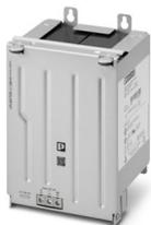
Batteriemodul, Lithium-Ion ( $\text{LiFePO}_4$ ), 24 V DC, 128 Wh. Zur Verwendung mit einer QUINT-UPS für Umgebungstemperaturen (Laden) von 0 °C ... 60 °C und maximalem Ladestrom von 5 A. Für Laden unter 0 °C bitte zulässige USV V/C Level beachten.
