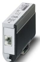
Überspannungsschutz gem. Class E<sub>A</sub> (CAT6<sub>A</sub>), für Gigabit-Ethernet (bis 10 GBit/s), Token Ring, FDDI/CDDI, ISDN, DS1. Geeignet für Power over Ethernet (PoE++ / 4PPoE) "Mode A" und "Mode B". RJ45-Zwischenstecker mit separater Erdungsleitung und Erdanschlussrastfuß für Tragschienen NS 35.
