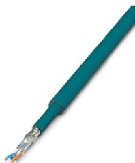
CAT5-SF/UTP-Kabel (J-02YS(ST)C HP 2 x 2 x 24 AWG), schweres Installationskabel 2 x 2 x 0,22 mm<sup>2</sup>, Massivleiter, geschirmt, Außenmantel: 7,8 mm Durchmesser, Innenmantel: 5,75 mm ± 0,15 mm Durchmesser, beidseitig konfekt. mit RJ45-Stecker, crossover oder line
