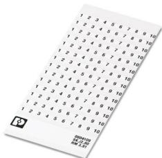
Kennzeichnungskarte, Bogen, weiß, beschriftet, längs: fortlaufende Zahlen 1 ... 10, 11 ... 20 usw. bis 91 ... (99)100, Montageart: kleben, für Klemmenbreite: 3,81 mm, Schriftfeldgröße: 3,81 x 2,8 mm, Anzahl der Einzelschilder: 14
