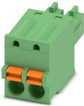
Leiterplattenstecker, Nennquerschnitt: 1,5 mm<sup>2</sup>, Farbe: grün, Nennstrom: 8 A, Bemessungsspannung (III/2): 160 V, Kontaktoberfläche: Zinn, Kontaktart: Buchse, Anzahl der Potentiale: 2, Anzahl der Reihen: 1, Polzahl: 2, Anzahl der Anschlüsse: 2, Artikelfamilie: FK-MCP 1,5/...-ST, Rastermaß: 3,81 mm, Anschlussart: Push-in-Federanschluss, Anschlussrichtung Leiter/Platine: 0 °, Stecksystem: COMBICON MC 1,5, Verriegelung: ohne, Befestigungsart: ohne, Verpackungsart: verpackt im Karton
