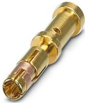
Crimpkontakt, Buchse, gedreht, Kontaktdurchmesser: 1 mm, Crimpbereich: 0,5 mm<sup>2</sup> ... 1 mm<sup>2</sup>, Alternativprodukt nach RoHS II ohne Ausnahme 6c (Pb < 0,1 %)
