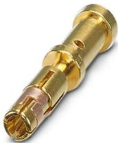
Crimpkontakt, Buchse, gedreht, Kontaktdurchmesser: 1 mm, Crimpbereich: 0,34 mm<sup>2</sup> ... 0,5 mm<sup>2</sup>, Alternativprodukt nach RoHS II ohne Ausnahme 6c (Pb < 0,1 %) Art.-Nr.: 1244919
