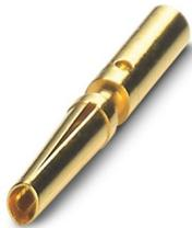
Crimpkontakt, Buchse, gedreht, Kontaktdurchmesser: 0,8 mm, Crimpbereich: 0,08 mm<sup>2</sup> ... 0,25 mm<sup>2</sup>, Alternativprodukt nach RoHS II ohne Ausnahme 6c (Pb < 0,1 %) Art.-Nr.: 1244455
