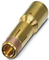
Crimpkontakt, Buchse, gedreht, Einzelkontakt, Kontaktdurchmesser: 3,6 mm, Crimpbereich: 10 mm<sup>2</sup> ... 10 mm<sup>2</sup>, Alternativprodukt nach RoHS II ohne Ausnahme 6c (Pb < 0,1 %) Art.-Nr.: 1244891
