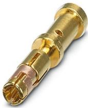
Crimpkontakt, Buchse, gedreht, Kontaktdurchmesser: 1 mm, Crimpbereich: 0,06 mm<sup>2</sup> ... 0,25 mm<sup>2</sup>, Alternativprodukt nach RoHS II ohne Ausnahme 6c (Pb < 0,1 %) Art.-Nr.: 1244919
