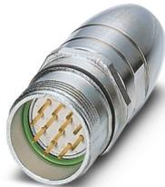
M23, Kupplungssteckverbinder, Serie: RC, gerade, geschirmt: ja, Schraubverriegelung, Polzahl: 17, Drehsinn: Standard, Kontaktart: Stift, Lötkehl, Kabeldurchmesserbereich: 3,5 mm ... 4,5 mm, Kodierung: N, Alternativprodukt nach RoHS II ohne Ausnahme 6c (Pb < 0,1 %) Art.-Nr.: 1243127
