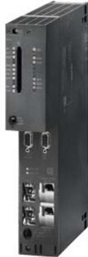
SIMATIC S7-400H, CPU 412-5H, Zentralbaugruppe für S7-400H und S7-400F/FH, 5 Schnittstellen: 1x MPI/DP, 1x DP, 1x PN und 2 für Sync-Module, 1 MB Speicher (512 KB Daten/512 KB Programm)
