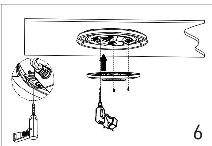
Verwenden Sie einen elektrischen Bohrer, um gemäß den auf der Deckenbasisplatte vorgesehenen Löchern 3 Löcher ( $\Phi 2,7$  mm) zu bohren. Befestigen Sie dann das Modul mit 3 Schrauben (PA3\*10).
