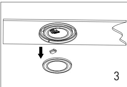
Entfernen Sie die alte Lichtquelle und reinigen Sie die Lampe vor dem Einbau unseres ReTUBE.
