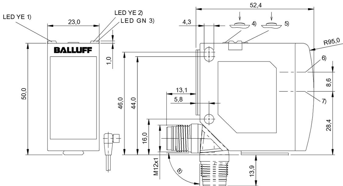
1) Ausgangsfunktion Q1, 2) Ausgangsfunktion Q2, 3) Betriebsspannung, 4) Einstellen Q1, 5) Einstellen Q2, 6) Optische Achse Sender, 7) Optische Achse Empfänger, 8) drehbar 270°
