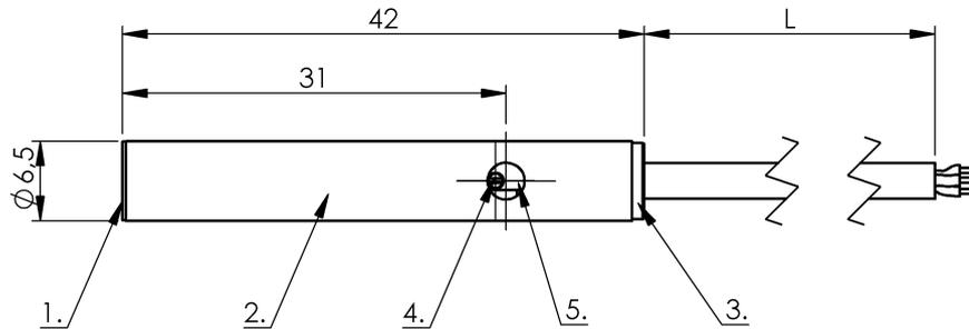
1) aktive Fläche, 2) Gehäuse, 3) Deckel, 4) Poti, 5) LED Funktionsanzeige
