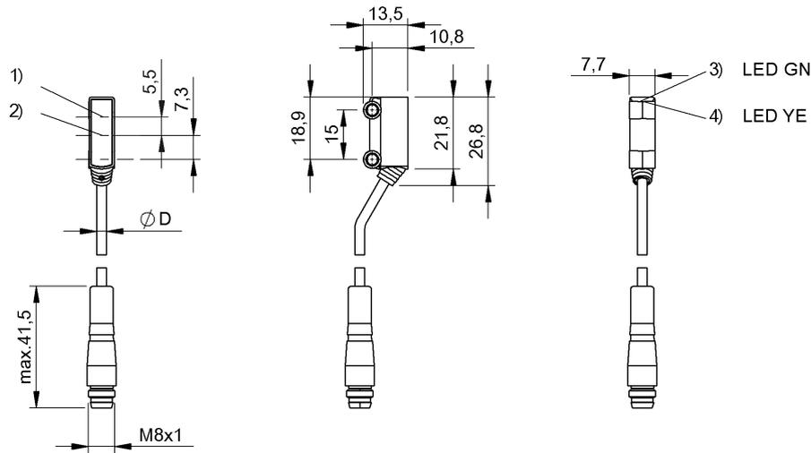
1) Optische Achse Empfänger, 2) Optische Achse Sender, 3) Betriebsspannung, 4) Lichtempfang
