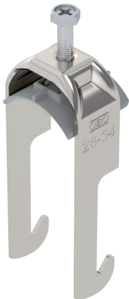
Bügel­schelle mit W-Fuß, Kunststoffdruckwanne aus Polypropylen. Zur vertikalen und horizontalen Montage von 1 Einzelkabel an Winkelleisen bis < 40 mm. Mit 1-gängiger Schraube an Druckwanne, universeller Sechskant-Schraubenkopf SW10, mit Schlitz und Kreuzschlitz. Geeignet für Montage im Innen- und Außenbereich. Der Einsatz einer Gegenwanne wird empfohlen.
