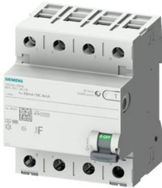
FI-Schutzschalter, 4-polig, Typ F, In: 40 A, 30 mA, 6mA DC, Un AC: 400 V, Elektro-Mobilität
