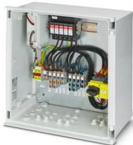
Generatoranschlusskasten für Photovoltaikanlagen bis 1000 V DC zum Anschluss von 2x 2 Strings. Mit Überspannungsschutz (Typ 1/2), DC-Feuerwehr-Lasttrennschalter mit Fernzugriff und Push-in-Anschluss für die Eingangs- und Ausgangsseite.
