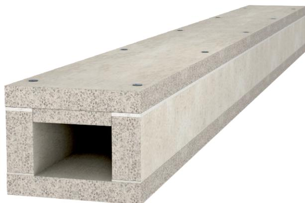
Brandschutzkanal zur brandsicheren Verlegung von Photovoltaikleitungen in und außerhalb von Gebäuden. Besteht aus nicht leitendem, frostbeständigem Glasfaserleichtbeton und erfüllt die Anforderungen an den Berührungsschutz für Einsatzkräfte im Brandfall. Als I30-Kanal nach DIN 4102 Teil 11 geprüft und zugelassen, daher einsetzbar in Flucht- und Rettungswegen. Inklusive Deckelschrauben und 3 m Dichtungstreifen.
