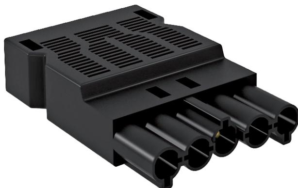
Steckerteil 5-polig, Typ GST18i mit Schraubanschluss für Leitungen 1,5 - 2,5 mm<sup>2</sup>, ein- und feindrätig, mit Zugentlastung, ein Anschluss pro Pol, unmontiert, für Leitungen H05VV (Ø 9,5 - 13,5) NYM und (Ø 10,5 - 13,5 mm), verriegelbar, gemäß Zugentlastung nach VDE 0628 ist eine Verriegelung vorzusehen, 250 V, 16 A.
