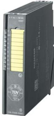
SIMATIC DP, fehlersicheres Elektronikmodul für ET200iSP, 4F-AI HART Ex I, bis Kategorie 4 (EN954-1)/ SIL3 (IEC61508)/PLE (ISO13849), zum Anschluss von (HART) 2-Draht Messumformern, unterstützte HART-Protokoll Version 7.0, Ex ib [ia Ga] IIC T4 Gb, Ex ib [ia IIIC Da] IIC T4 Gb, Ex ib [ia] I Mb
