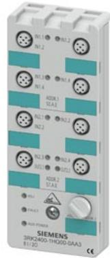
AS-i Kompaktmodul K60 digital A/B-Slave, 8DI/2DQ, IP67 3 x 2 Eingänge und 2 x 1 Eingang / 1 Ausgang max. 200 mA Sensorversorgung Ausgänge 2 A, DC 24 V 8 x M12-Buchse mit Y-Belegung Montageplatte 3RK1901-0CA00 ist separat zu bestellen
