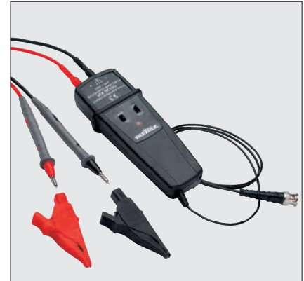
Differenzspannungssonde MX 9030 _____ MX 9030-Z gem. IEC 61010-1, CAT IV-2 Ermöglicht die Anzeige von hohen Differenzspannungen bis \pm 600 V auf einem Oszilloskop bei voller Sicherheit. Bandbreite: 30 MHz Siehe S. 161
