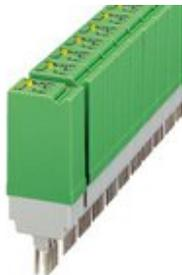
Relaisstecker, bestückt mit Kleinschaltrelais, Kontakte (AgPd60): kleine Leistungen, 1 Wechsler, Eingangsspannung 24 V AC/DC, mit Leuchtanzeige, steckbar auf Grundklemmenblöcke
