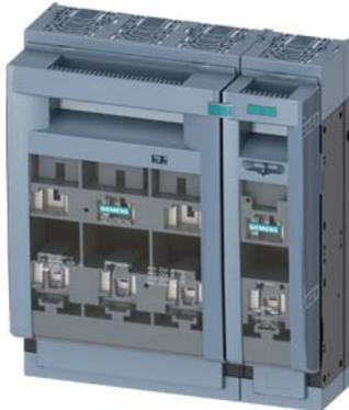
SENTRON, Sicherungslasttrennschalter 3NP1, 4-polig, NH1, 250 A, für Aufbau und Einbau auf Montageplatte, Flachanschluss, Abdeckebene 70mm
