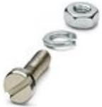
Schraubensatz, zur Befestigung des Grundgehäuses an der Gerätewand, bestehend aus je einer M3 x 10-Schraube, einem Federring und einer Mutter
