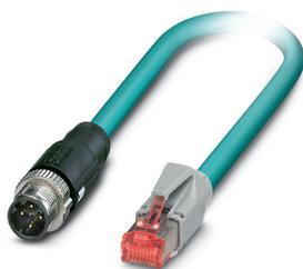
Netzwerkkabel, Ethernet CAT5 (100 MBit/s), 4-polig, PUR, wasserblau RAL 5021, geschirmt, Stecker gerade M12 SPEEDCON / IP67, Kodierung: D, auf Stecker gerade RJ45 / IP20, Kabellänge: 20 m
