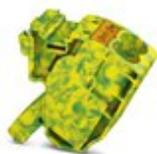
Abgriffklemme, Zur Verwendung mit den Power-Turn-Hochstromklemmen PTPOWER 50, 95,150 und 185, Nennspannung: 1500 V, Nennstrom: 57 A, Anschlussart: Push-in-Anschluss, Anzahl der Anschlüsse: 2, Querschnitt: 0,5 mm<sup>2</sup> - 16 mm<sup>2</sup>, AWG: 20 - 6, Breite: 18,5 mm, Höhe: 34,7 mm, Farbe: grün/gelb, Montageart: auf Basiselement
