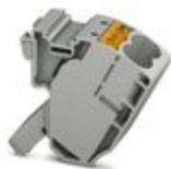
Abgriffklemme, Zur Verwendung mit den Power-Turn-Hochstromklemmen PTPOWER 50, 95,150 und 185, Nennspannung: 1500 V, Nennstrom: 57 A, Anschlussart: Push-in-Anschluss, Anzahl der Anschlüsse: 2, Querschnitt: 0,5 mm<sup>2</sup> - 16 mm<sup>2</sup>, AWG: 20 - 6, Breite: 18,5 mm, Höhe: 34,7 mm, Farbe: grau, Montageart: auf Basiselement
