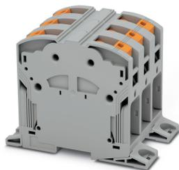
Hochstromklemme, geblockt, Nennspannung: 1500 V DC / 1000 V AC, Nennstrom: 309 A, Anschlussart: Power-Turn-Anschluss, Anzahl der Anschlüsse: 6, Polzahl: 3, Querschnitt: 95 mm<sup>2</sup> - 185 mm<sup>2</sup>, AWG: 3/0 - 350 kcmil, Breite: 93 mm, Höhe: 108,3 mm, Farbe: grau, Montageart: direktes Anschrauben
