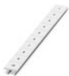
Zackband, Streifen, weiß, beschriftet, beschriftbar mit: CMS-P1-PLOTTER, quer bedruckt: fortlaufende Zahlen 1 ... 10, 11 ... 20 usw. bis 91 ... 100, Montageart: verrasten in hoher Schildchennut, für Klemmenbreite: 10,2 mm, Schriftfeldgröße: 10,15 x 10,5 mm, Anzahl der Einzelschilder: 10
