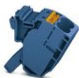
Abgriffklemme, Zur Verwendung mit den Power-Turn-Hochstromklemmen PTPOWER 50, 95,150 und 185, Nennspannung: 1500 V, Nennstrom: 57 A, Anschlussart: Push-in-Anschluss, Anzahl der Anschlüsse: 2, Querschnitt: 0,5 mm<sup>2</sup> - 16 mm<sup>2</sup>, AWG: 20 - 6, Breite: 18,5 mm, Höhe: 34,7 mm, Farbe: blau, Montageart: auf Basiselement
