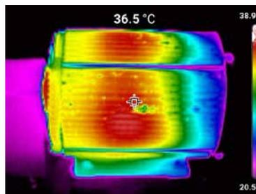
Wärmebild eines Motors mit der Wärmebildkamera Fluke TiS55+
