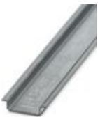
Tragschiene ungelocht, Standardprofil, Breite: 35 mm, Höhe: 7,5 mm, nach EN 60715, Material: Stahl, verzinkt, Länge: 2000 mm, Farbe: silberfarben
