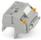
V8-Adapter für 8 x PLC-INTERFACE (6,2 mm), Steuerung: SPS-Systemverkabelung von Eingangskarten, Anschluss 1: Schraubanschluss 1x, Anschluss 2: D-SUB-Buchsenleiste 1x 15-polig, Anschluss 3: Steckanschluss (Aufrastbar auf 8x PLC-INTERFACE-Klemmen), Anzahl der Kanäle: 8, Ansteuerlogik: plusschaltend
