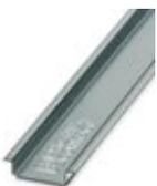
Tragschiene ungelocht, Standardprofil, Breite: 35 mm, Höhe: 7,5 mm, nach EN 60715, Material: Aluminium, unbeschichtet, Länge: 2000 mm, Farbe: silberfarben
