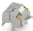
V8-Adapter für 8 x PLC-INTERFACE (6,2 mm), Steuerung: SPS-Systemverkabelung von Eingangskarten, Anschluss 1: Schraubanschluss 1x, Anschluss 2: IDC/FLK-Stiftleiste 1x 14-polig, Anschluss 3: Steckanschluss (Aufrastbar auf 8x PLC-INTERFACE-Klemmen), Anzahl der Kanäle: 8, Ansteuerlogik: minusschaltend
