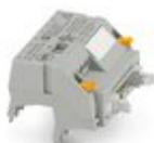
V8-Adapter für 8 x PLC-INTERFACE (6,2 mm), Steuerung: SPS-Systemverkabelung von Eingangskarten, Anschluss 1: Schraubanschluss 1x, Anschluss 2: IDC/FLK-Stiftleiste 1x 14-polig, Anschluss 3: Steckanschluss (Aufrastbar auf 8x PLC-INTERFACE-Klemmen), Anzahl der Kanäle: 8, Ansteuerlogik: plusschaltend
