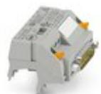
V8-Adapter für 8 x PLC-INTERFACE (6,2 mm), Steuerung: SPS-Systemverkabelung von Eingangskarten, Anschluss 1: Schraubanschluss 1x, Anschluss 2: D-SUB-Stiftleiste 1x 15-polig, Anschluss 3: Steckanschluss (Aufrastbar auf 8x PLC-INTERFACE-Klemmen), Anzahl der Kanäle: 8, Ansteuerlogik: plusschaltend
