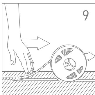
Rollen Sie das LED-Band nicht komplett ab. Entfernen Sie die Schutzfolie des Klebestreifens, während Sie das LED-Band gleichzeitig abrollen.
