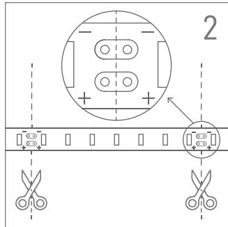
Das LED-Band darf nur zwischen Lötspuren geschnitten werden.
