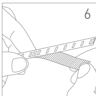
Entfernen Sie das Klebeband von der Rückseite des LED-Bandes.
