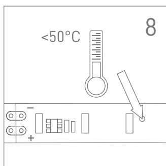
Die LED-Bänder müssen auf Aluminium (oder Material mit ähnlicher Wärmeleitung) installiert werden, um eine ausreichende Wärmeableitung zu erreichen. Die Betriebstemperatur darf 50°C nicht überschreiten.
