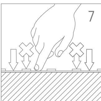
Drücken Sie das LED-Band vorsichtig zwischen den elektronischen Komponenten auf die Aluminiumoberfläche.
