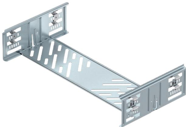
Kabelrinnenverbinder mit Schnellbefestigung für die schraubenlose Verbindung von gelochten Kabelrinnen mit der Seitenhöhe 85 mm.
