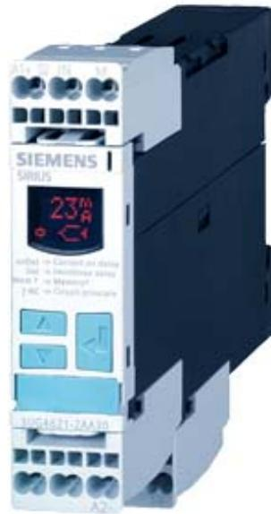
Digitales Überwachungsrelais Stromüberwachung, 22.5 mm von 2-500 mA AC/DC Über- und Unterschreitung Versorgungsspannung: AC/DC 24 V DC und AC 50 bis 60 Hz ohne galvanische Trennung zum Messkreis Anlauf- und Störspitzenverzög. 0,1 bis 20 s Hysterese 0.1 bis 250 mA 1 Wechsler mit oder ohne Fehlerspeicher automatisches RESET Federzugtechnik
