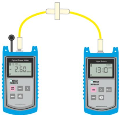
Lösen Sie nun das Messkabel am Pegelmesser und verbinden Sie das offene Ende über eine Kupplung mit z.B. der zu messenden Faserstrecke. Das andere Ende der Faserstrecke wird nun mit dem Pegelmesser verbunden. Beachten Sie, dass die Verbindung am Pegelsender nicht gelöst, bzw. nicht verändert wird.
