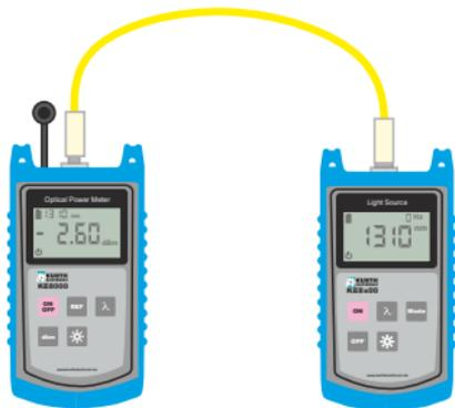
Verbinden Sie die Lichtquelle und den Pegelmesser KE8000 mit einem hochwertigen optischen Messkabel.
