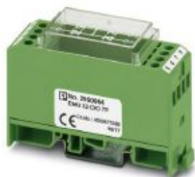
Dioden-Modul, zur Erweiterung mit 7 Dioden 1N 4007, gemeinsame Kathode
