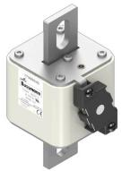
Sicherungseinsatz, superflink, 800 A, AC 690 V, size 3, 76 x 76 x 150 mm, aR, IEC, einfacher Kennmelder
