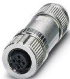
Datensteckverbinder, INTERBUS (500 kBit/s), 5-polig, geschirmt, Buchse gerade M12, Kodierung: B, Push-in-Anschluss, Rändelmaterial: Zinkdruckguss, vernickelt, Kabelaußendurchmesser 4 mm ... 8 mm
