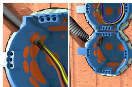
Kabel einfach durch Cable-Plopp durchstecken oder Membrane mit Cuttermesser öffnen und Rohre einführen.
