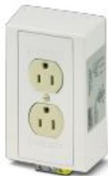
Auf einer Tragschiene montierte Doppelsteckdose mit zwei 120 V AC/15 A-Buchsen zur Montage an einer 35 mm Tragschiene gemäß EN 60715. Für erhöhte Sicherheit befindet sich der Erdungsstift an der Oberseite, um Kurzschlüsse zwischen den spannungsführenden und spannungsfreien Zungen zu vermeiden.
